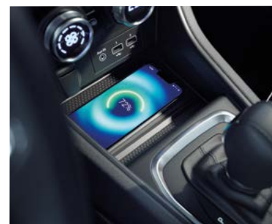
▲ Bezdrátová nabíječka Indukční nabíjení chytrých telefonů.
